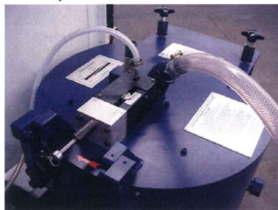
Třífázový separátor SMR 100 – jádro systému
